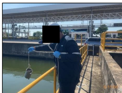
รูปที่ 3-3 การเก็บตัวอย่างน้ำทิ้ง ในช่วงดำเนินการ บริเวณบ่อกักน้ำทิ้งของโครงการ ระหว่างเดือนกรกฎาคม-ธันวาคม พ.ศ. 2566
