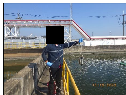
รูปที่ 3-3 การเก็บตัวอย่างน้ำทิ้ง ในช่วงดำเนินการ บริเวณบ่อกักน้ำทิ้งของโครงการ ระหว่างเดือนกรกฎาคม-ธันวาคม พ.ศ. 2566
